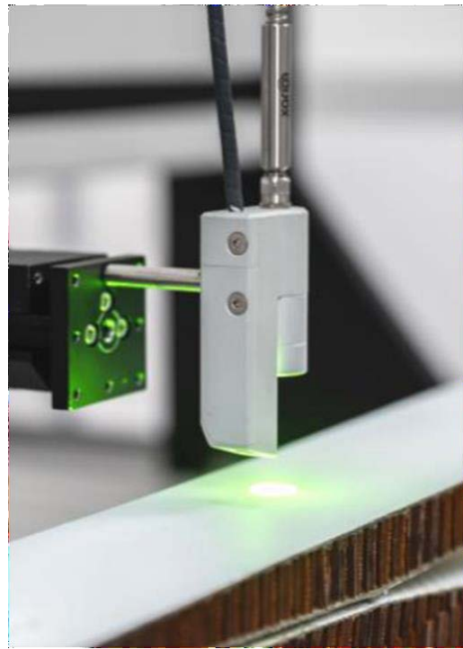
单侧扫描：激发激光与光学麦克风一体式布置在被测物的同一侧
